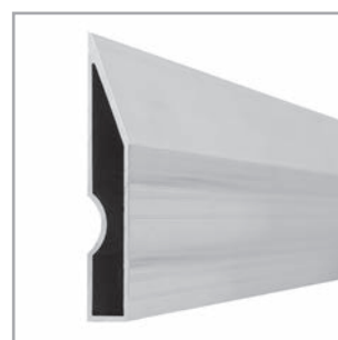
Przekrój poprzeczny profilu łaty tynkarskiej trapezowej o wymiarach 94 mm × 18 mm. Grubość profilu 1,5 mm, masa profilu 0,84 kg/m.
