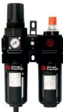
Zestaw do powietrza 8940171929 korpus aluminiowy, maks. ciśnienie 15 bar, maks. przepływ 2 600l/min.
