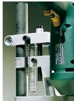
ogranicznik głębokości wiercenia
