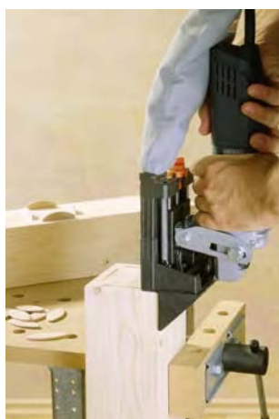
frezowanie pod kątem
