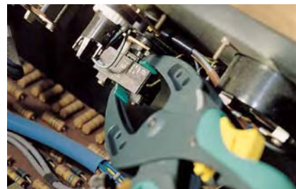
długie, wąskie szczęki umożliwiają mocowanie również w trudno dostępnych miejscach
