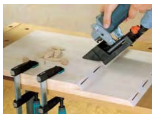
frezowanie pod kątem
