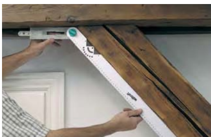
skala do pomiaru kątów
