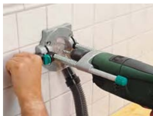
dodatkowy uchwyt dla dokładnego ustawienia i zabezpieczenia przed przemieszczeniem wiertarki podczas wiercenia
