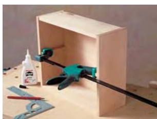
prosta przebudowa do funkcji rozpieraka
