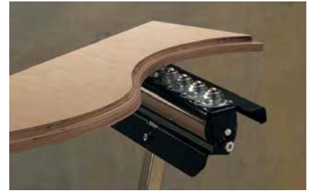
podparcie kulkami łożyskowymi pozwala na przemieszczanie obrabianego materiału we wszystkich kierunkach, np. podczas frezowania
