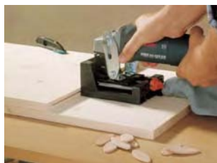
połączenie za pomocą płytek
