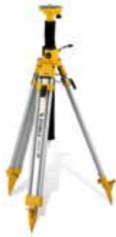
Typ BST-K-L Statyw budowlany z kolumną korby i blokadą uniemożliwiającą rozsuwanie się statywu. Wysokość: maks. 220 cm Waga: 6,5 kg
