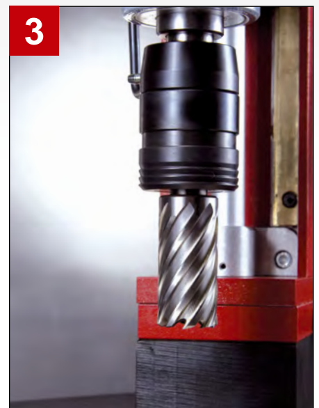
Rys. 4: Aby wymienić wiertło koronowe, należy przesunąć pierścień zabezpieczający do góry.
