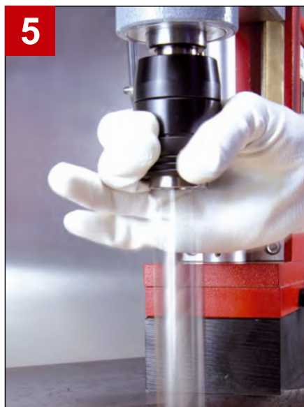
Rys. 4: Aby wymienić wiertło koronowe, należy przesunąć pierścień zabezpieczający do góry.
