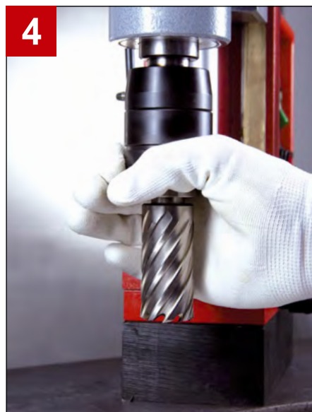
Rys. 3: Wiertło koronowe znajduje się w EasyLock. Obrabiarka jest przygotowana do pracy.
