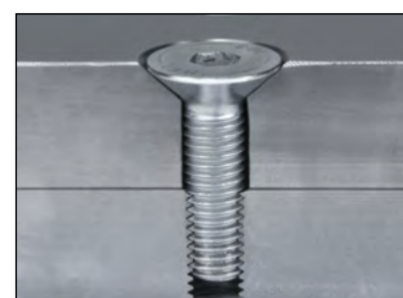
4. Osiowe zaszlifowanie pogłębiacza w technologii CBN
