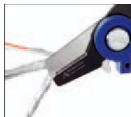
Schneiden der Paarschirmung Cutting the double shielding
