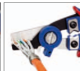
Schneiden der Innenleiter Cutting the conductors
