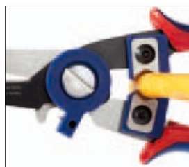
Abmanteln des Außenmantels mittels austauschbarem Formmesser
