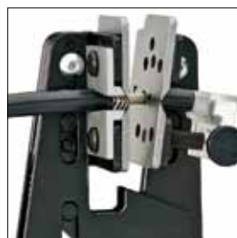
Abisolieren durch Formmesser Stripping with profile blades
