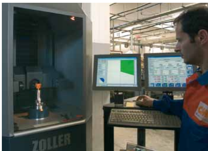
W pełni zautomatyzowany proces pomiaru kontrolnego.
