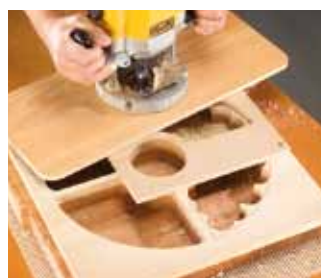
Wykonaj frezowanie wykończeniowe używając dołączonego freza oraz tulei.
