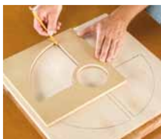
Odrysuj kształt na materiale roboczym, wykorzystując szablony zawarte w zestawie.
