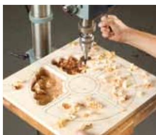
Używając wiertarki pionowej, wstępnie wyfrezuj kształt odrysowany od szablonu.
