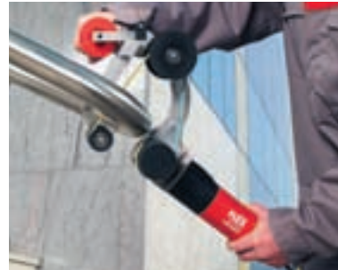
Czysta i płynna praca podczas szlifowania i polerowania łuków rury.
