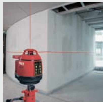
Określanie linii trasujących jest szybko wykonane za pomocą rotującego kręgu promieniowania, także na zaokrąglonych powierzchniach ścian. W pełni automatyczny laser rotacyjny ALR 512.
