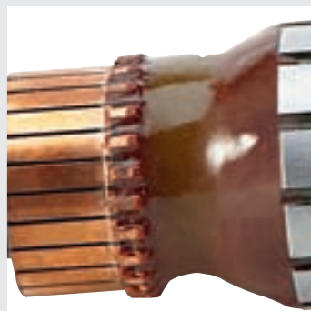
Opancerzone uzwojenie na tworniku (strona komutatora).
