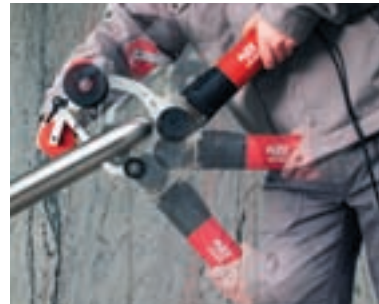
Całkowita obróbka rur bez widocznych przejść z Boa FLEX.
