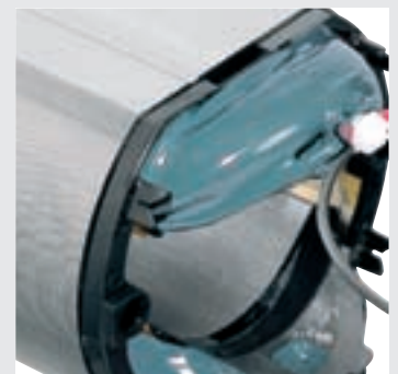
Uzwojenie na pakiecie czołowym jest także zabezpieczone epoksydowo.
