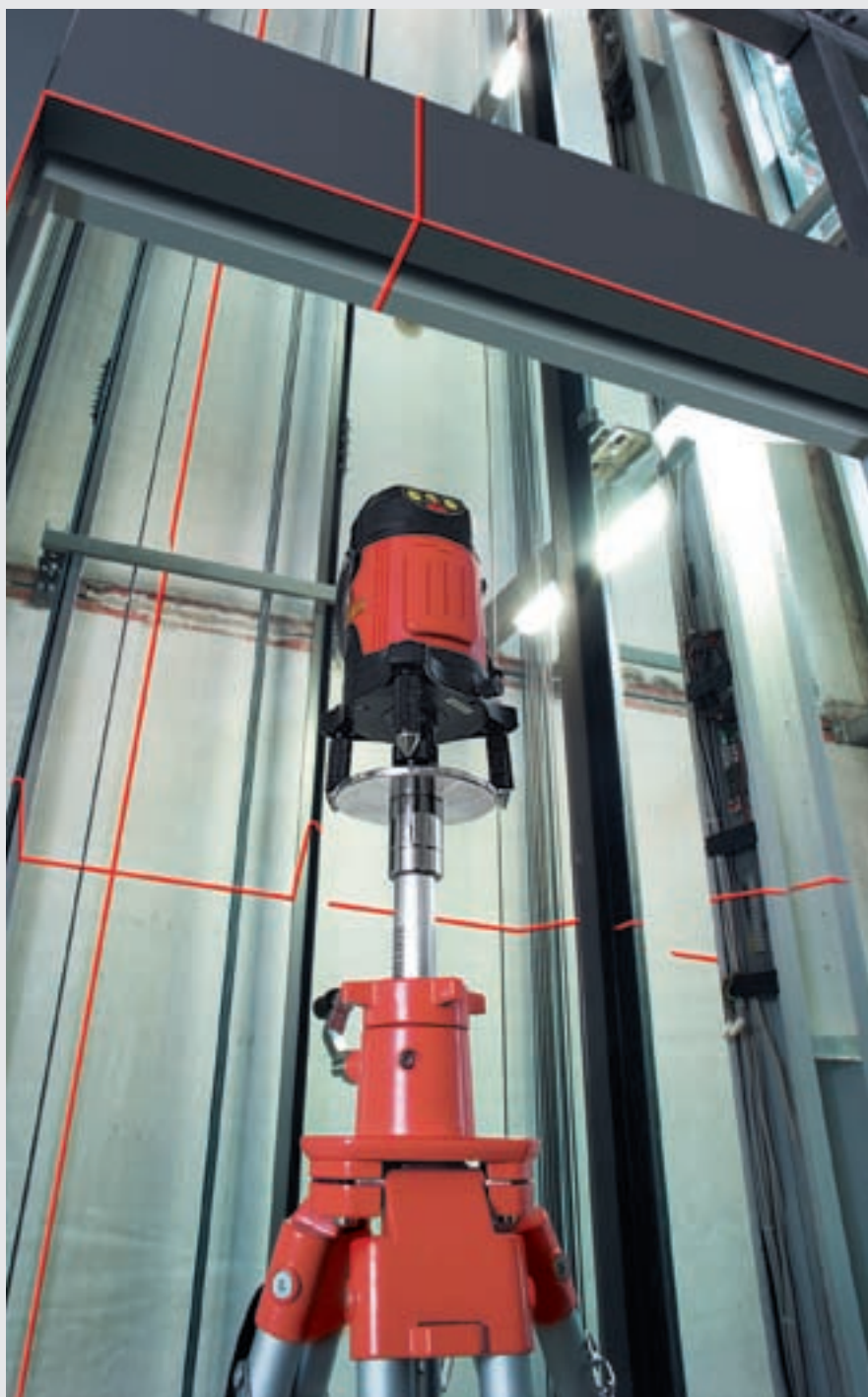
Za pomocą linii laserowej i dwóch dołączanych linii pionowych, można rzutować płaszczyzny odniesienia i zadbać w ten sposób o szybką niwelację montażu.
