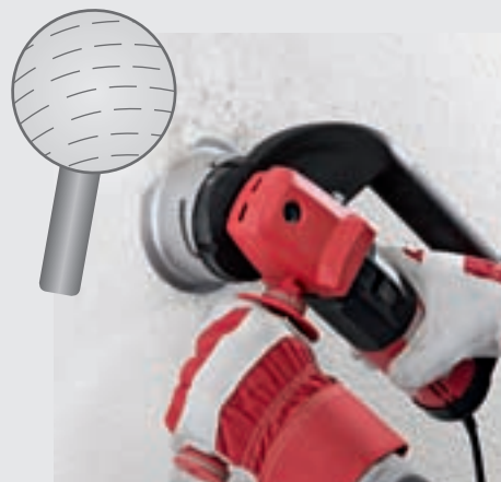
Perforowanie tapet pokrytych farbą możliwe jest z nowoczesnym perforatorem posiadającym tnące koła. Przyspiesza to wnikanie płynów (rozpuszczalników do tapet).
