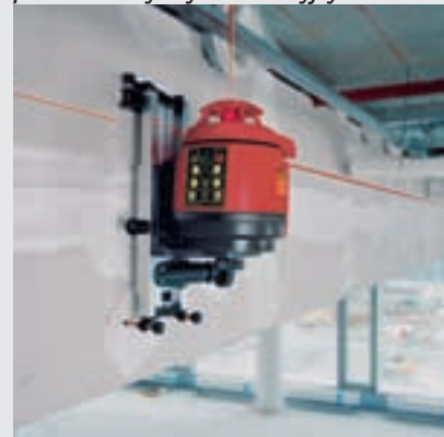
Zwisanie z sufitu staje się dziecinną igraszką dzięki laserowi rotacyjnemu, zdalnej obsłudze i opcjonalnym uchwytem ściano - sufitowym.
