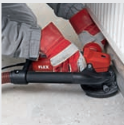
Odsysanie działa także z otwartym segmentem szczotek.
