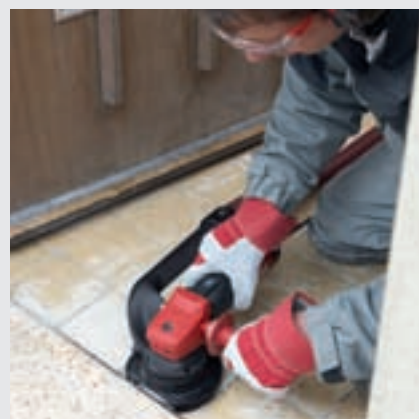
Odchylny segment szczotek jest idealny do prac blisko krawędzi.
