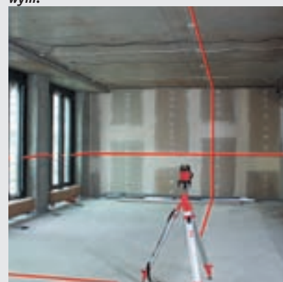
Laser wielo liniowy dla najwyższych wymagań. Stała widoczna linia laserowa symuluje w zakresie kątowym 180° późniejszy podział pomieszczeń Samopoziomujący się laser wielo liniowy ALC 514
