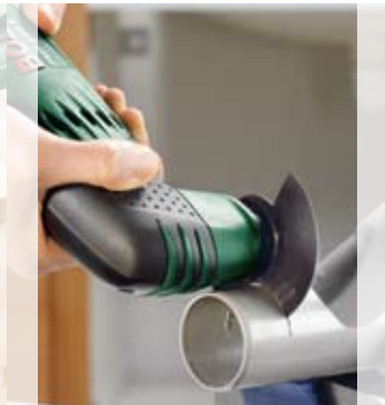
Skracanie rur odpływowych.
