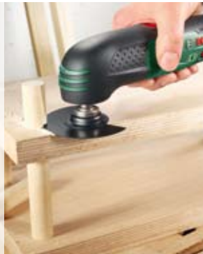
Usuwanie elementów drewnianych na równi z powierzchnią.
