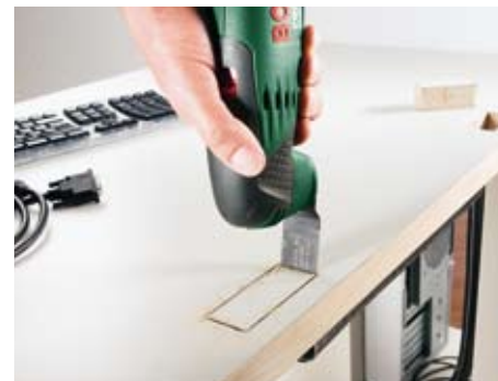
Wycinanie otworów w meblach.
